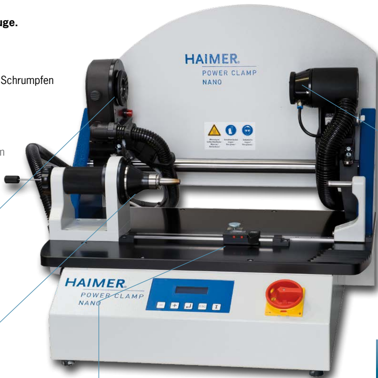
Luftkühlung (optional) Luftkühlung für konturabhängige und sichere Kühlung von kleinen Schrumpffuttern
