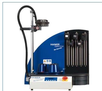
Power Clamp Profi Plus NG Hochleistungs-Schrumpfgerät – Schrupfleistung 20 kW – Zum Schrumpfen von Werkzeugen mit \varnothing 3–50 mm – Für HSS- und HM-Werkzeuge – Große Spule für \varnothing 40–50 mm (Optional) – Inkl. Drehteller und Aufnahmehalter – Inkl. Werkzeugablage – Inkl. Schwenkfächer für Zubehör
